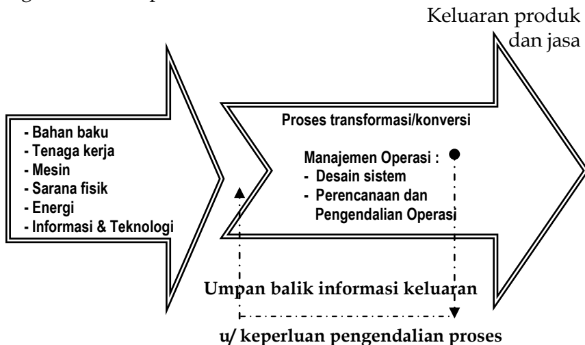
Gambar 4.2 Sistem Produksi sebagai Proses Transformasi atau Konversi (Buffa,1993:9)
