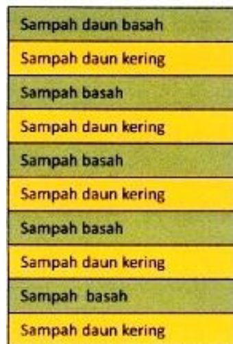
Gambar 3.5. Gambaran Susunan Campuran Sampah Daun Kering Dengan Sampah Basah Seperti Susunan Kue Lapis
