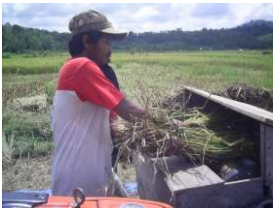
Gambar 33. Alat Mesin Perontok Padi “Thresher” yang dikembangkan BBP Mekanisasi Pertanian.
