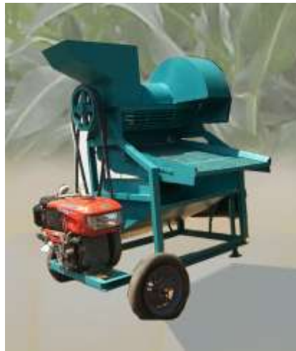
Gambar 37. Mesin Pemipil Jagung Tanpa Kupas Kelobot (BBP Mekanisasi Pertanian)
